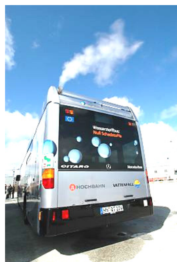
Abb. 30 Wasserdampf als „Abgas“ eines Brennstoffzellenbusses
