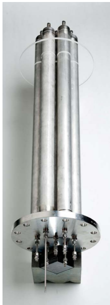
Abb. 42 Helmholtz-Zentrum Geesthacht - Metallhydridspeicher auf Aluminiumbasis, ca. 1 m lang
