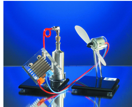
Abb. 46 Die gleiche Brennstoffzelle treibt einen Propeller an
