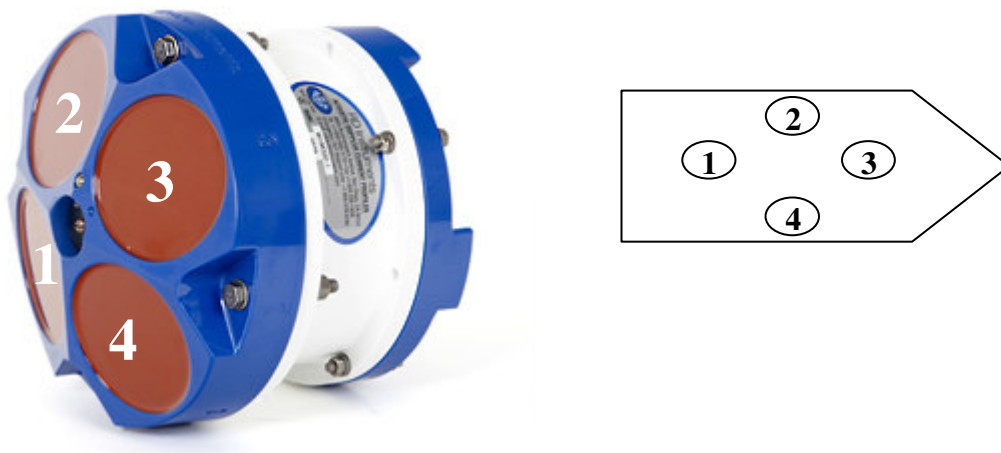
Abb.2.2: RDI ADCP vom Typ Monitor mit vier Schwingern sowie die Ausrichtung der Schwinger beim Schiffsinsatz. Adaptiert von RDI. (Quelle: http://www.rdinstruments.com/monitor.aspx , besucht am 24.10.2010).
